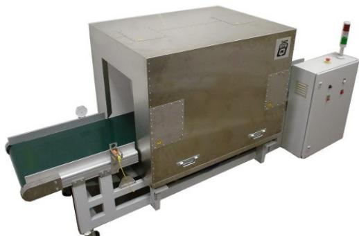
При необходимости регистрации большого числа меток в небольшой зоне с линейными размерами менее метра оправдано использование тоннелей или боксов, содержащих антенны, окружающие зону регистрации с возможно большего числа сторон и направлений, и внешние экранирующие элементы, предотвращающие «паразитные» регистрации меток снаружи.
