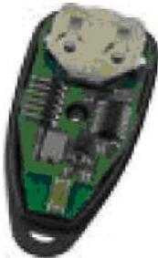
Активные RFID-метки обладают собственным источником питания и не зависят от энергии считывателя, вследствие чего они читаются на дальнем расстоянии (до 300 м), имеют большие размеры, больший объем памяти и могут быть оснащены дополнительной электроникой. Однако, такие метки наиболее дороги, а у батарей ограничено время работы.
