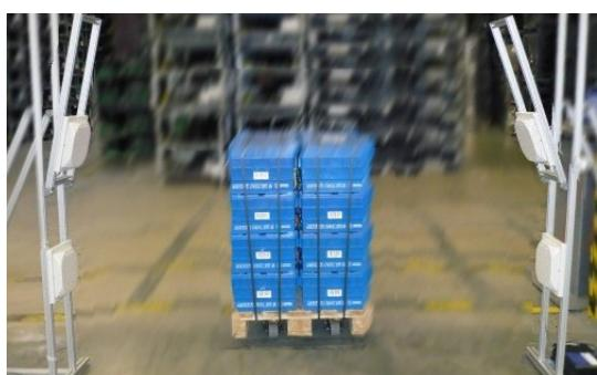
Портальные (воротные) зоны регистрации окружают антеннами, подключенными к стационарному считывателю, зону перемещения объектов с метками с боковых сторон и/или сверху. Например, регистрация меток товаров на провозимой паллете, меток персонала, проходящего через зону контроля, меток товаров, двигающихся по транспортерной ленте, меток книг, проносимых пользователями на выходе из библиотеки. Типичные размеры портальной зоны — до 3 метров в ширину и высоту.
