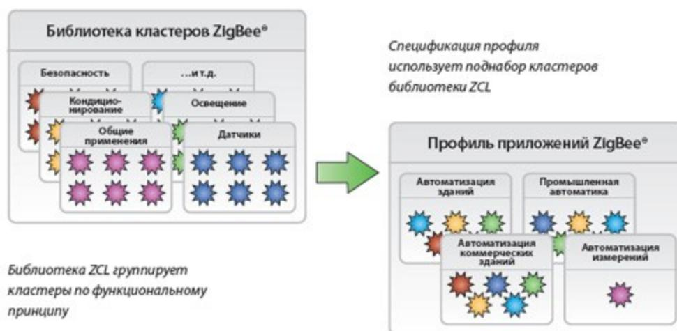
Все запросы данных посылаются в профиль приложения. Для этого используются идентификаторы профиля — 16-разрядные числа в диапазоне 0x0000–0x7fff для стандартных профилей и 0xbf00–0xffff — для профилей, определенных производителем.
