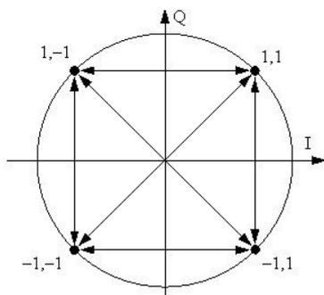
При квадратурной фазовой манипуляции QPSK (Quadrature Phase Shift Keying или 4-PSK) используется созвездие из четырёх точек, размещённых на равных расстояниях на окружности. На символ приходится два бита. Скорость может быть увеличена в два раза относительно BPSK при той же полосе сигнала, либо оставить скорость прежней, но уменьшить полосу вдвое.
